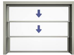
Fenêtre avec deux sections coulissantes
