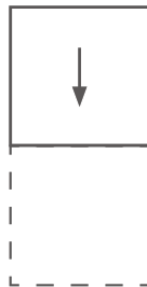
Glissement vertical ouverture vers le bas, intégré dans le mur.
